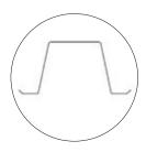
Latte de toit D'âme: 40 x 87,5 mm (1.57x3.45") Latte de plafond: 22-61mm (0.87x2.4"). Plage d'épaisseur de 0,4 mm à 0,8 mm (épaisseur 26-22)
