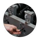
Un système de calibrage simple et intuitif permettant d'alterner rapidement des épaisseurs comprises entre 1,2 et 3,2 mm.
